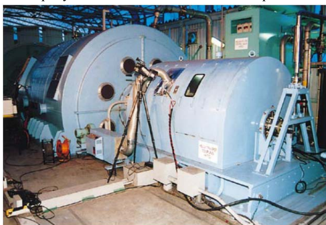
Рис. 3. Японский генератор Super-GM мощностью 70 МВт (слева); многожильный Nb-Ti-кабель с пониженными потерями на переменном токе (справа), 1997 год.
