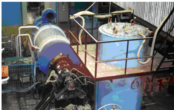
Рис. 2. СП генератор КТГ-20 на 20 МВт, СССР, начало 80-х [4].
