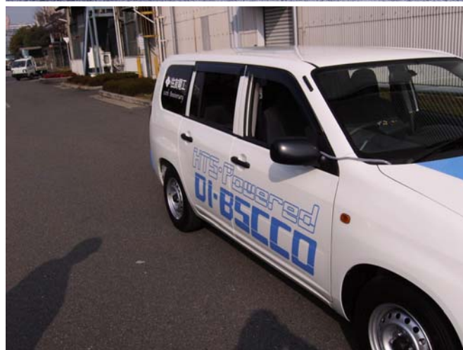
Рис. 1. Тойота со сверхпроводниковым электродвигателем Sumitomo Electric Industries.
