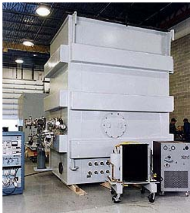
Рис. 5. ВТСП трансформатор на 1 МВ·А
