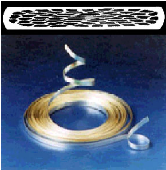
Рис. 1. Фото ленты Bi-2223/Ag , полученной во ВНИИНМ. В верхней части рисунка – поперечное сечение ленты.
