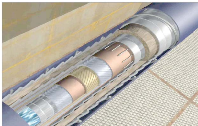
Рис. 4. Кабель SuperPower Inc, изготовленный из ВТСП лент 1-го поколения, для подземной локальной линии электропередач на заводах Southwire Company.
