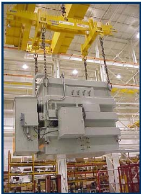
Рис. 1. Трёхфазный ВТСП трансформатор мощностью 5/10 МВА. [5]
