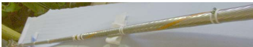
Рис. 2. Кабель в защитной обмотке из нержавеющей стали
