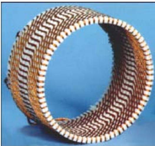
Рис. 4. Сегмент статорной катушки, намотанной из семижильного MgB 2 провода ( J = 310\,000\text{ A/cm}^2 at 20 K)
